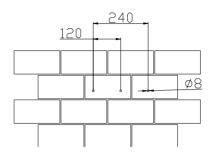
Figure 4.7 Drill holes' dimensions of R5-3K/3.6K/4K/5K/6K/7K/8K-S2 R5-3K/3.6K/4K/5K/6K/7K/8K-S2-15
