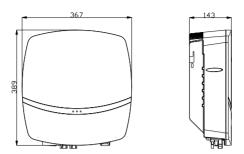
Figure 3.3 Dimensions of R5-3K/3.6K/4K/5K/6K-S2 R5-3K/3.6K/4K/5K/6K-S2-15
